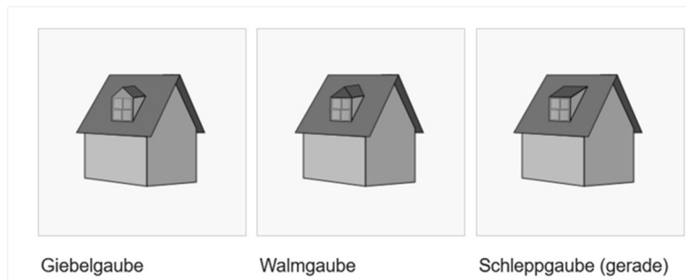
Abbildung 1: Gaubenarten, Quelle: https://de.wikipedia.org/wiki/Dachgaube
